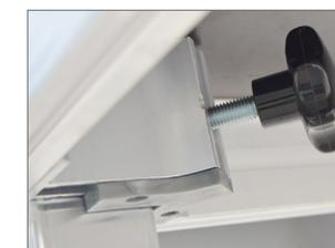
**Escuadra de aluminio reforzada** para patas redondas o cuadradas sujeta mediante dos tornillos M12. Para colocar las patas hay que introducirlas en el compartimento y ajustarlas a través del pomo en forma de estrella.
